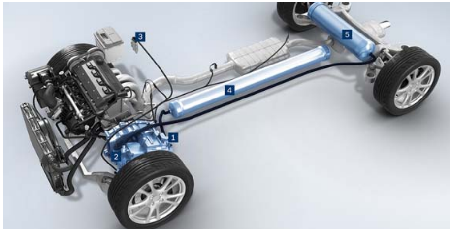
Fig. 3.3. Sistem de propulsie Bosch și PSA Peugeot Citroën
