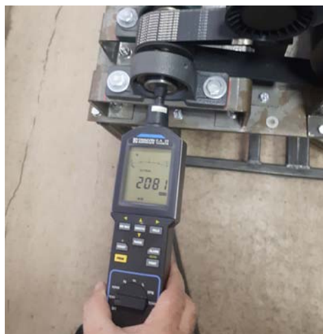
Fig. 8.8. Citirea turației folosind cuplarea mecanică.
