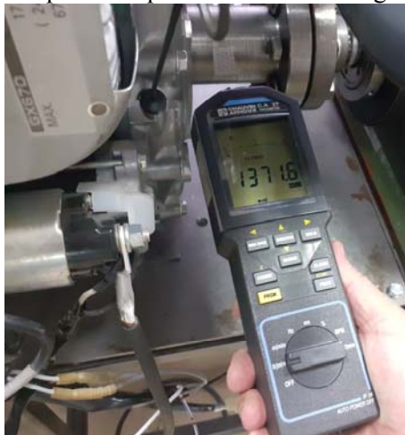
Fig. 8.7. Citirea optică a turației.
