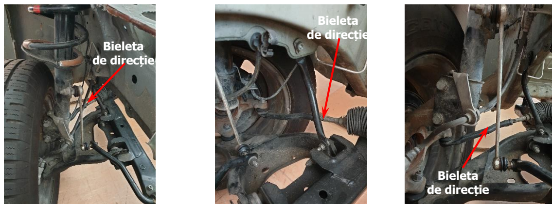
Figura 3.4. Punte tip McPherson
