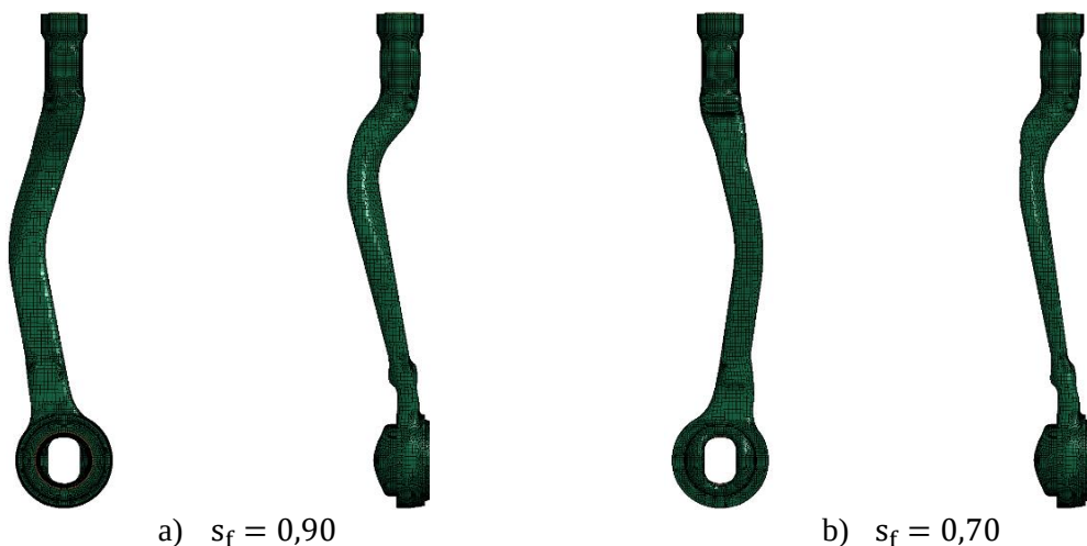
Figura 6.6. Model numeric Corp Bieletă de Direcție conform s_f
