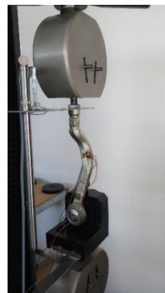
Figura 5.14. Ansamblul Bieletă de Direcție în timpul testului
