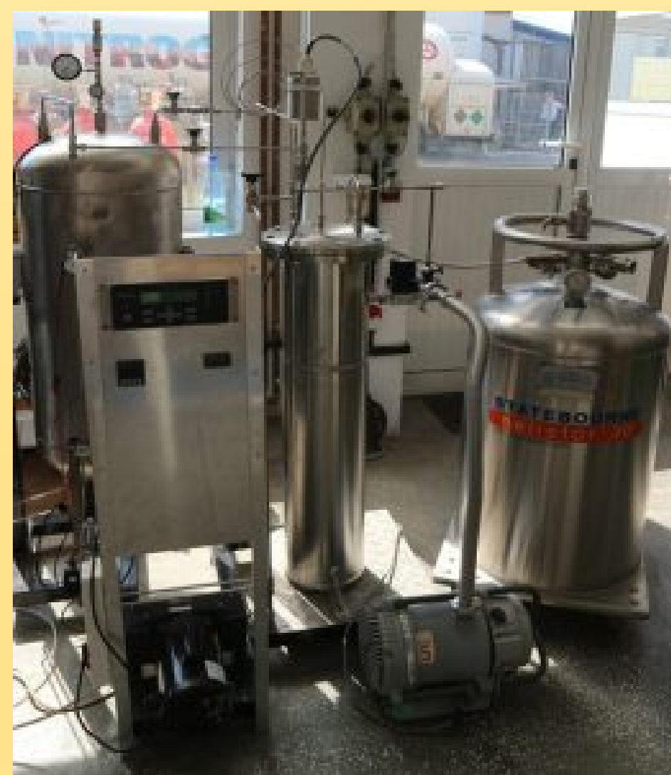
Stand experimental de crioabsorbție și criocondensare pentru SMES
