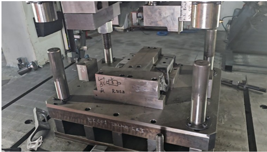
Figura 3.19. Procesul tehnologic de realizarea a piesei mobile. a) echipamentul tehnologic pentru operațiile de îndoire; b) echipamentul tehnologic pentru operațiile de decupare
