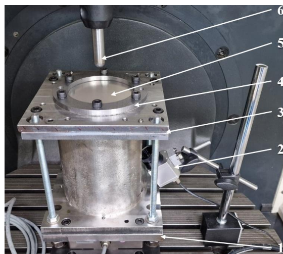
Stand experimental pentru cercetarea proceselor de deformare plastică incrementală
