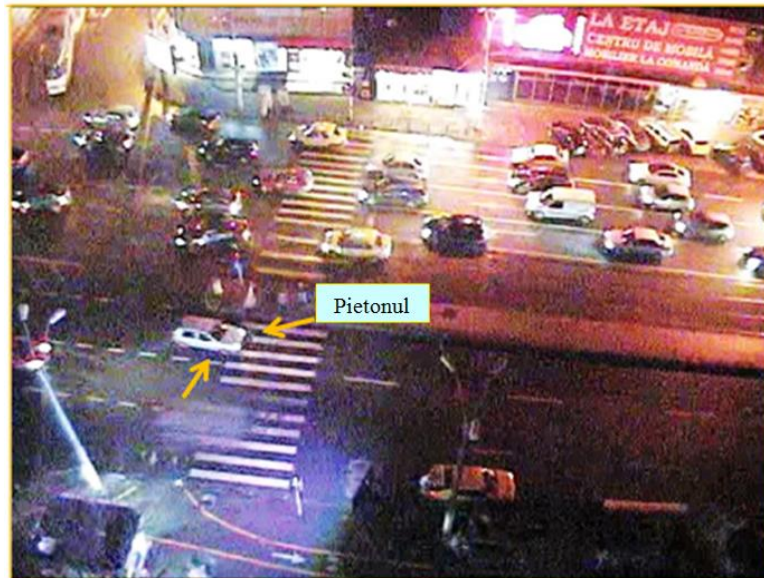
Figura 3.2. Secvența din înregistrarea video a accidentului ce ilustrează momentul inițial al impactului, în care bara de protecție față a autovehiculului lovește pietonul, la nivelul membrelor inferioare
