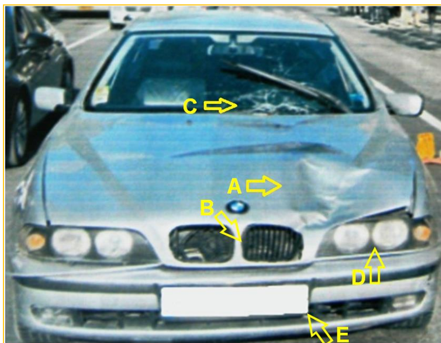
Figura 3.16. Avariile produse la autoturismul BMW în urma impactului cu pietonul
