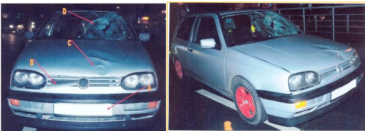
Figura 3.4. Avariile produse la autoturismul VW în urma impactului cu pietonul
