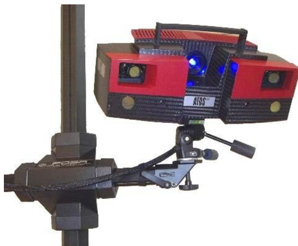
Figura 2.2. Echipamentul de scanat ATOS III
