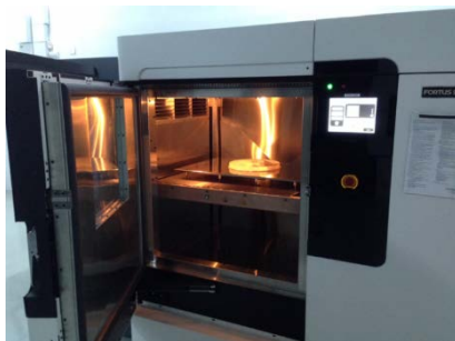
Figura 2.43. Mașina de tipărit și piesa 3D la sfârșitul procesului de tipărire.
