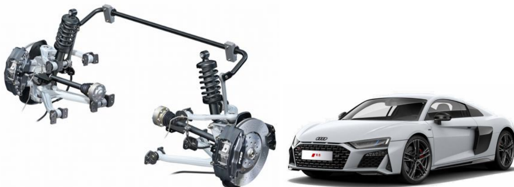
Fig 1.10. Suspensie spate independentă cu brațe duble folosită de AUDI R8 [169].
