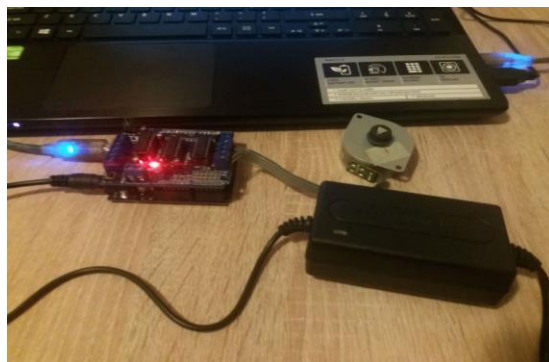
Fig. 7.24. Sistem mecatronic pentru comanda amortizorului.
