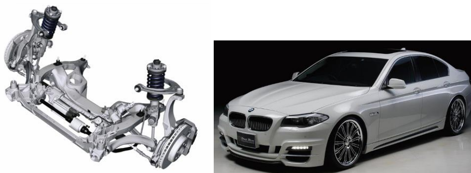
Fig. 1.9. Suspensie față independentă cu brațe duble folosită de BMW SERIA 5 [177].
