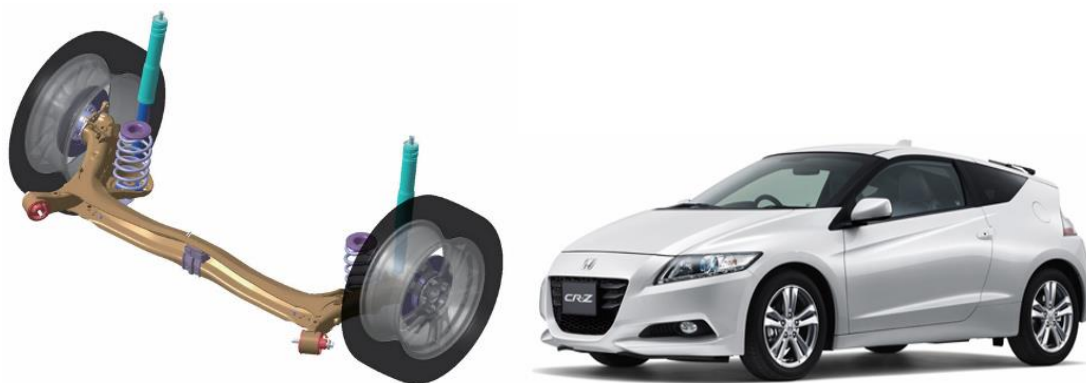
Fig. 1.3. Suspensie spate semi-independentă folosită de Honda CR-Z [174].
