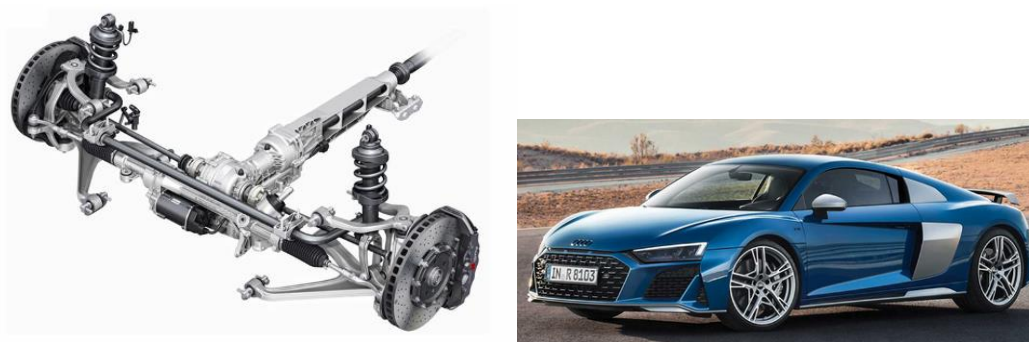
Fig. 1.7. Suspensie față independentă cu brațe duble folosită de AUDI R8 COUPE[169].
