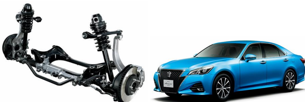
Fig. 1.8. Suspensie față independentă cu brațe duble folosită de TOYOTA CROWN ATHLETE[176].
