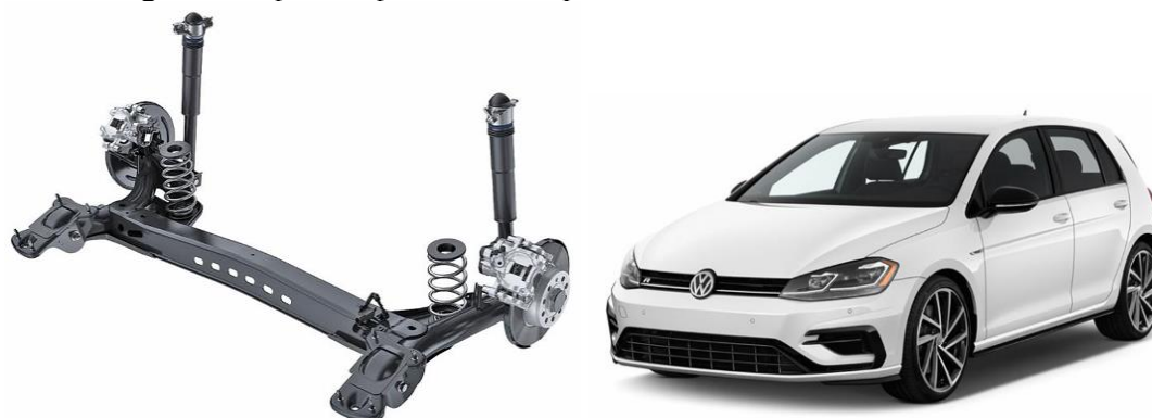
Fig. 1.4. Suspensie spate semi-independentă folosită de Golf VII [175].
