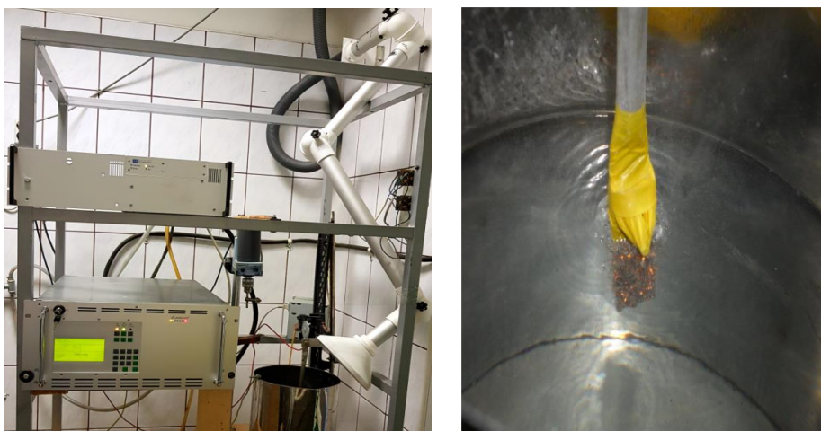
Instalația de oxidare în plasmă electrolică (PEO)
