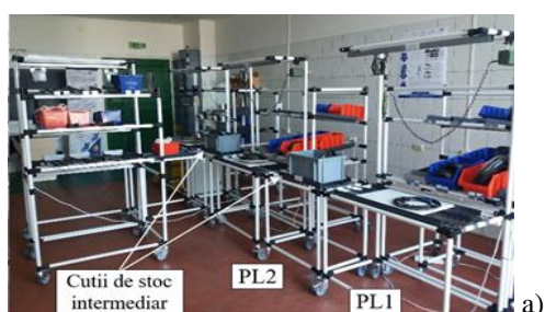
Figura 7. Demonstratorul experimental – linia de asamblare în cea de-a doua variantă de organizare spațială: a) imagine din laborator; b) schița 2D a implantării
