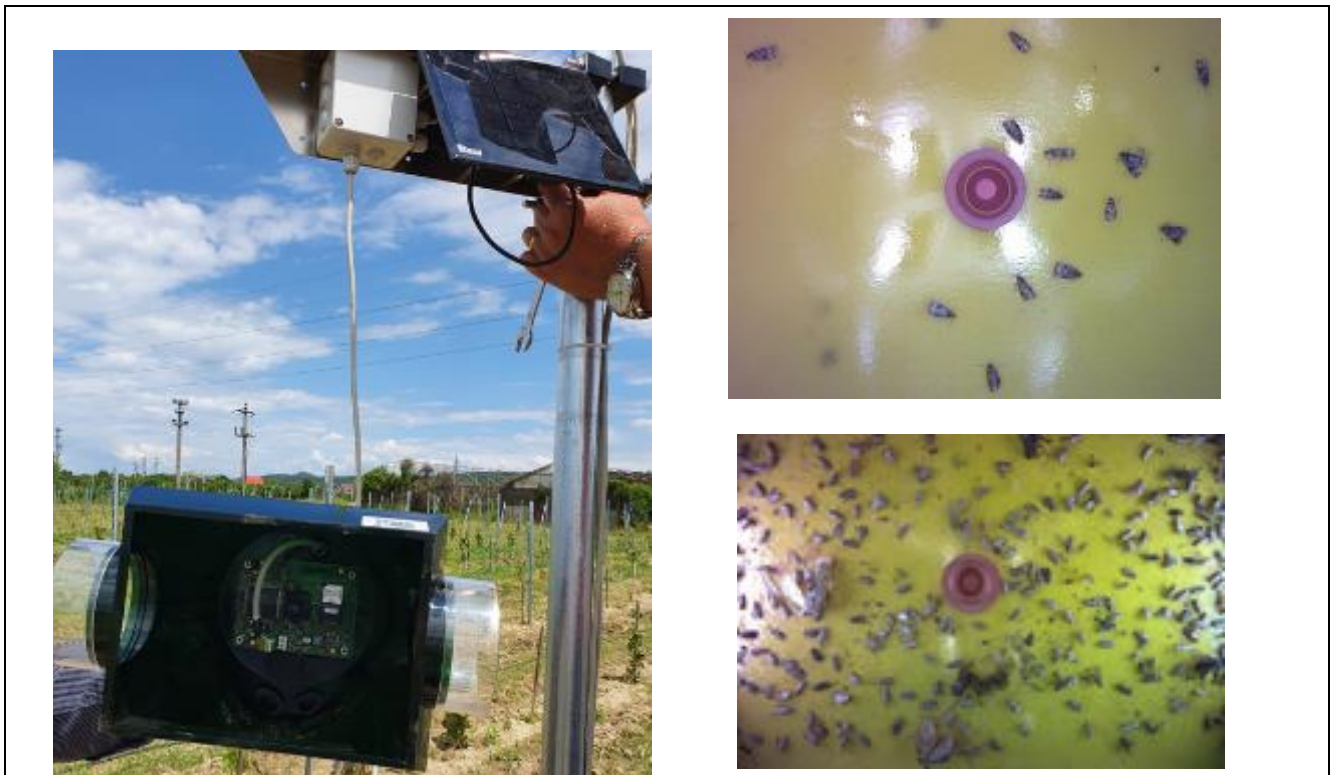
Fig.5. Sistemul video de preluare imagini de pe o capcană cu feromoni pentru determinarea gradului de atac al dăunătorilor.
