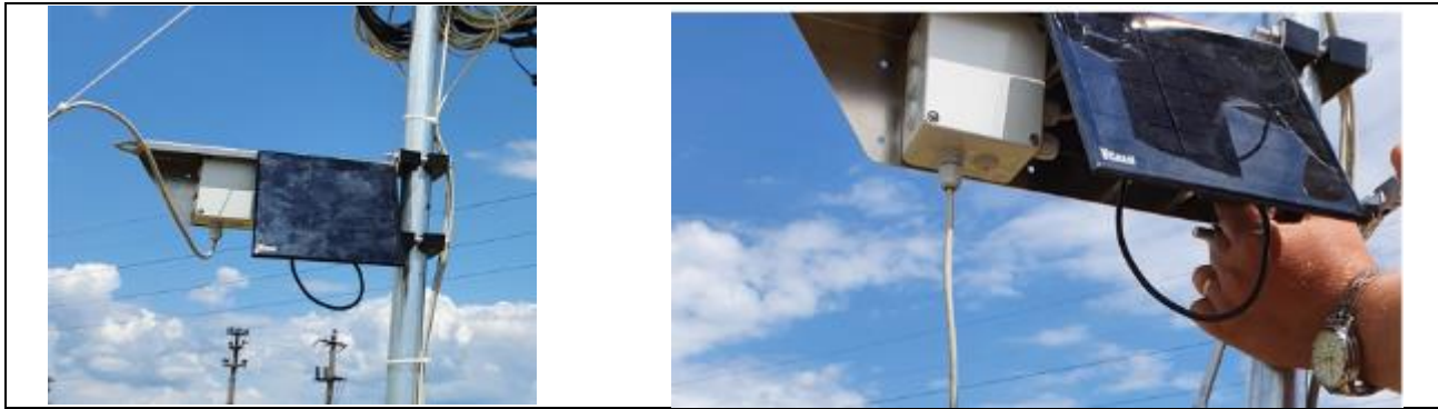
Fig. 4. Sistem de alimentare pentru sistemul video de preluare imagini de la capcana cu feromoni
