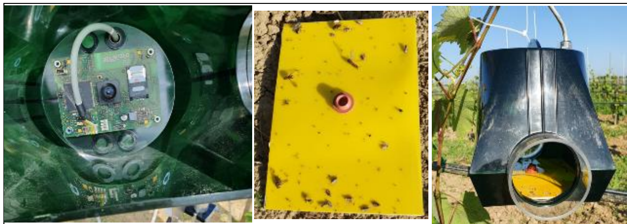
Fig. 3. Sistem de preluare imagini de la capcana cu feromoni, Capcana cu feromoni și sistemul asamblat pentru preluare imagini
