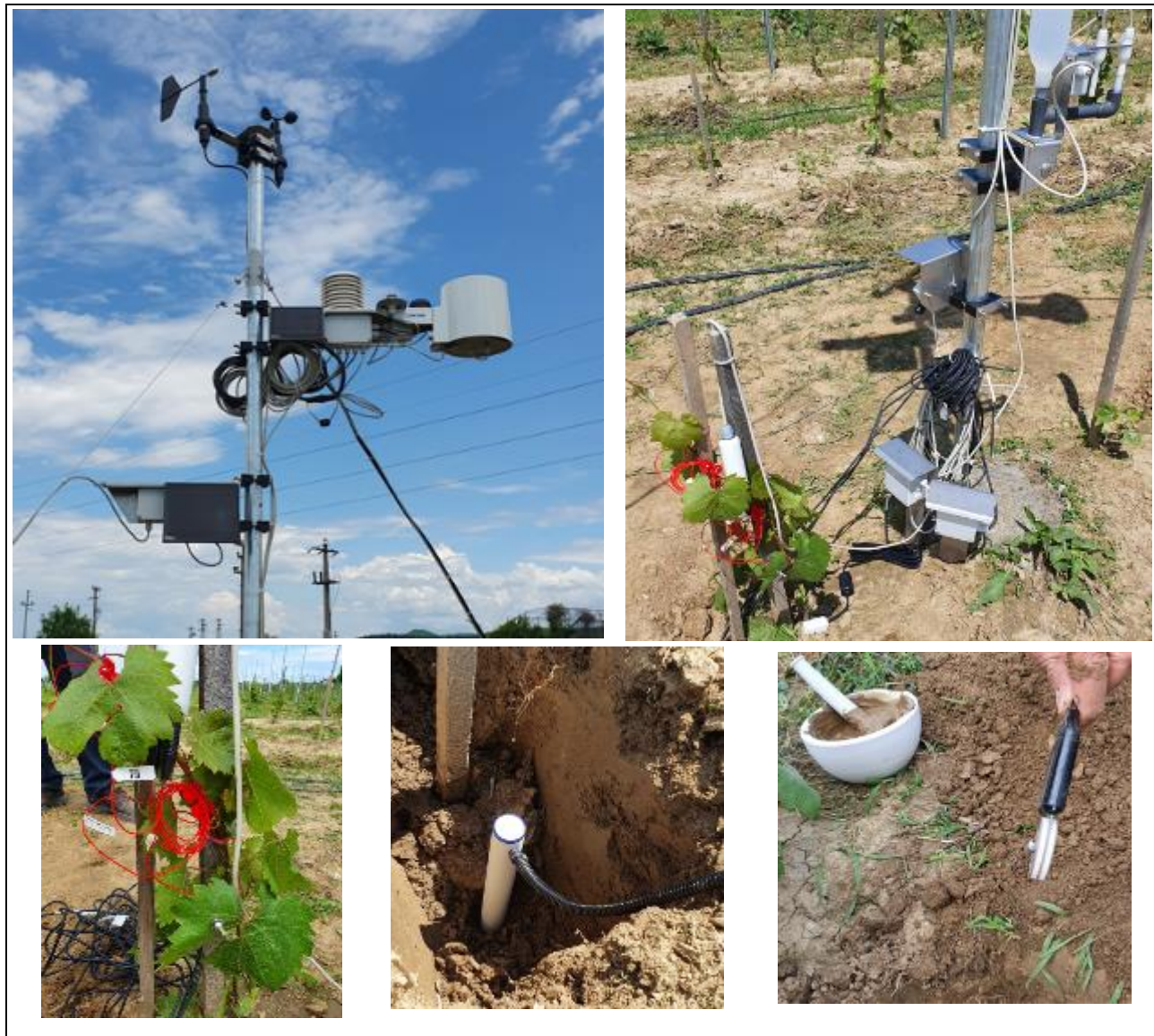
Fig. 3. Sistem electronic complex pentru monitorizarea condițiilor de apariție a stresului hidric în horticultură instalat în custodia partenerului P1 - ICDP Mărăcineni
