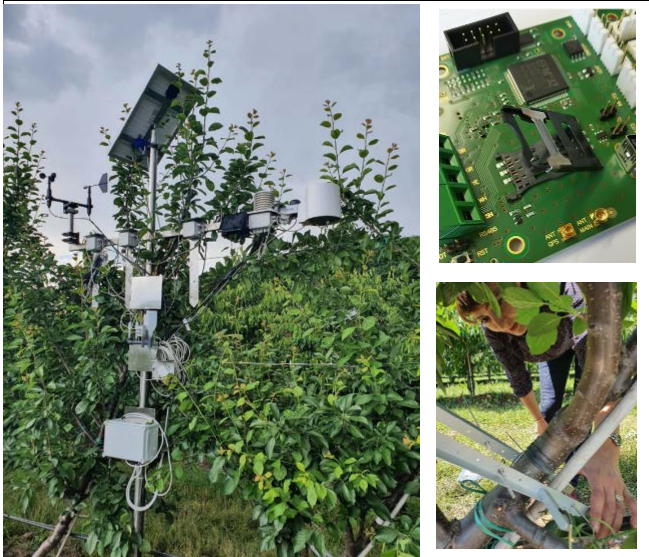
Fig. 3. Sistem electronic complex pentru monitorizarea condițiilor de apariție a stresului hidric în horticultură instalat în custodia partenerului P1 - ICDP Mărăcineni
