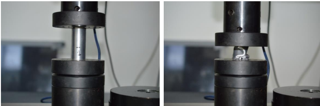
Figura 3.5 Primul specimen (înainte și după comprimare) supus unei sarcini axiale [109]
