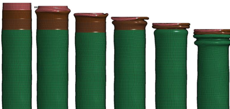
Figura 3.20 Fazele deformării unei structuri – simulare cu deformare [117]
