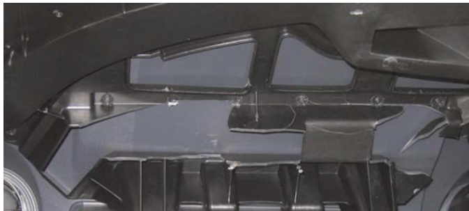
Figura 5.2. Structura de rezistență a planșei bord[100]
