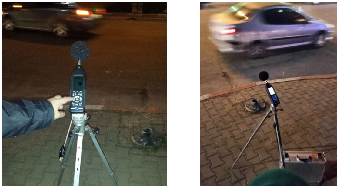
Fig. 6.10. Instalarea și utilizarea sonometrului pentru măsurarea zgomotului.
