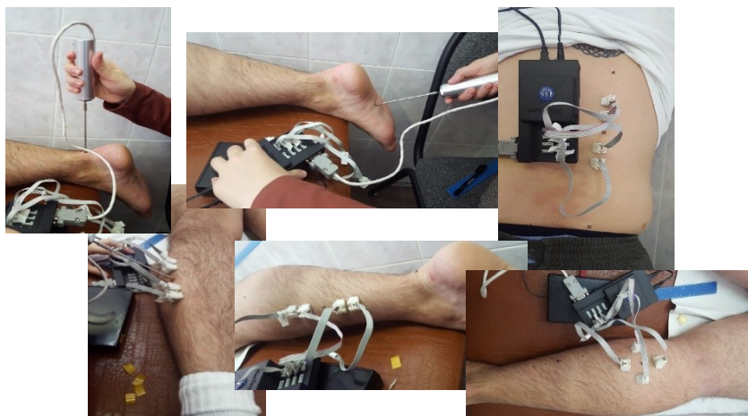
Figura 11. Modul de plasare a accelerometrelor în timpul experimentului în cadrul experimentului din Rusia
