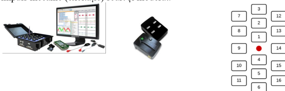
Figura 1. Dispozitiv Trigno și mod de aplicare accelerometre pe piele (Delsys, 2017)
