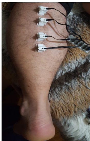
Figura 5. Poză experiment cu modul de plasare a accelerometrelor pe mușchiul investigat
