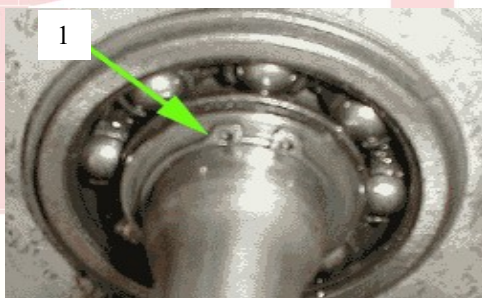
Fig. 1.1 Rulment roată (Times New Roman 11 ppt): 1 – inel de siguranță, 2 - etc.
